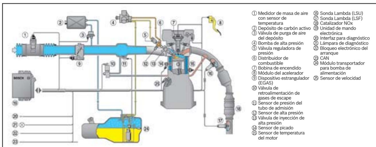
En los motores con inyección directa de gasolina, la mezcla aire-combustible se produce directamente en la cámara de combustión. En la carrera de admisión, circula solamente aire fresco a través de la válvula de admisión abierta. Con válvulas de inyección especiales, se inyecta el combustible bajo alta presión directamente en la cámara de combustión. La dosificación exacta, la preparación y la distribución del aire y del combustible para cada ciclo de combustión individual,
