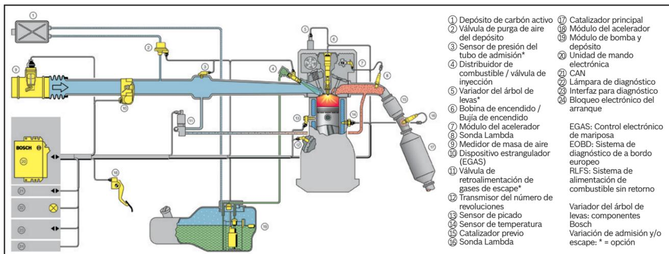
La función principal del control del motor es el ajuste del par de giro deseado por el conductor, con un óptimo consumo de combustible y las más bajas emisiones. El sistema de gestión del motor ME-Motronic combina para ello todos los sistemas parciales necesarios: el pedal acelerados electrónico (EGAS) ajusta el aire necesario para la generación de este momento. En el sistema
